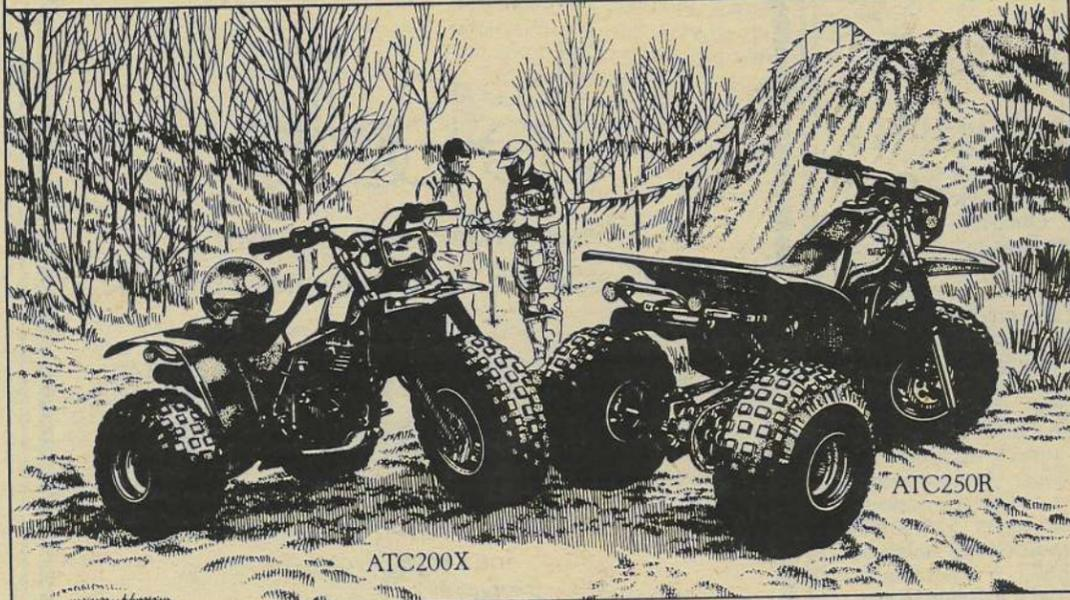
Ces trois roues ne demandent qu'à se mesurer à la concurrence ou à partir pour une randonnée palpitante. Il s'agit de l'ATC250R 1983 et du tout nouveau ATC200X. Tous deux sont caractérisés par des fourches pneumatiques à l'avant et une suspension souple à amortisseur simple à l'arrière qui absorbe les creux et les bosses. Une large surface de roulement arrière et un grand pneu avant étroit leur donnent un aspect sport et facilitent leur maniabilité. Notre 250R est équipée
